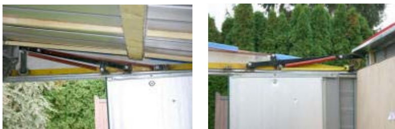
Les ressorts en situation ouverture et fermeture. Cliquez sur les images
