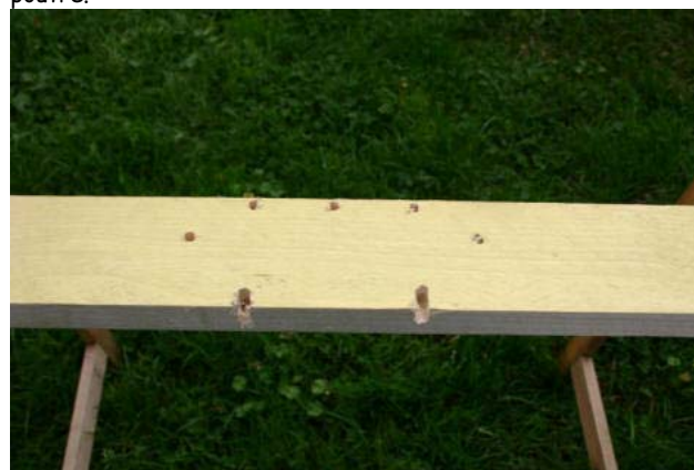
Après marquage de la poutre, évidez les emplacements pour monter la planche.
